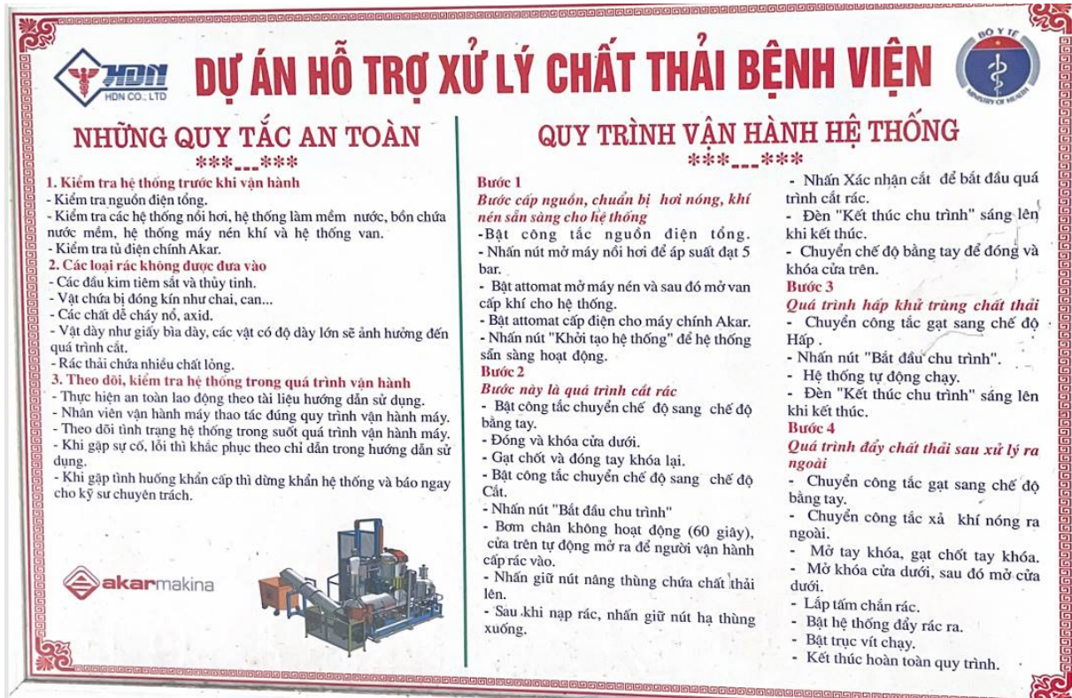
Hình 3.23. Bảng hướng dẫn quy trình vận hành hệ thống xử lý CTNH tại cơ sở
